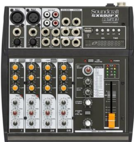
Figura 22: Modelo de mesa de som 6 canais.
