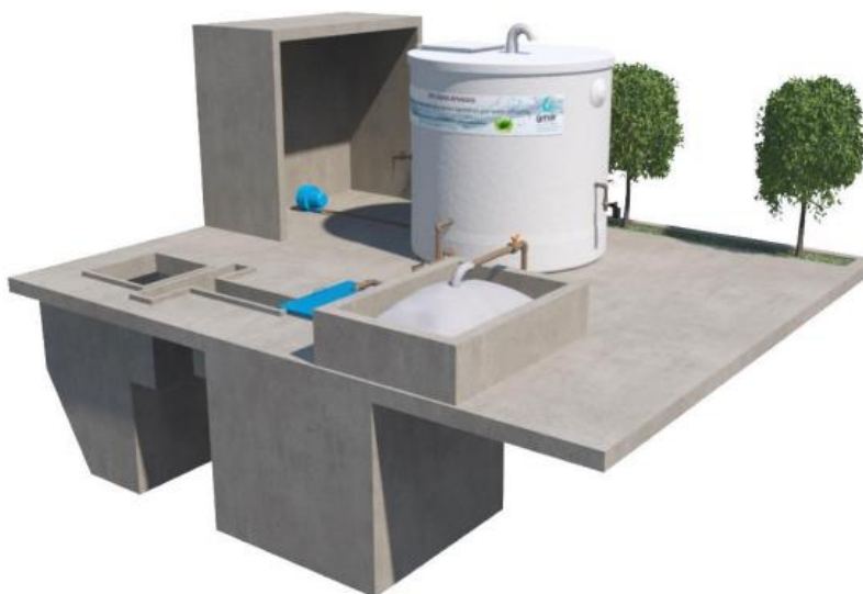
Figura 2: Modelo do sistema da ETE Compacta (GMAR ou similar).
